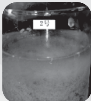
圖 2-1 一分鐘後產生大量絮狀物
